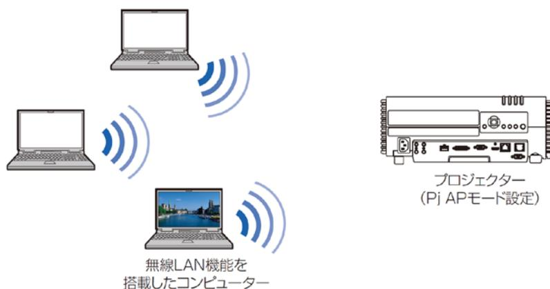
PJ APモード以外に、プロジェクターをKUINS Air等に接続した状態として、アクセスポイント経由でPCからプロジェクターに接続するインフラストラクチャモードでの利用形態もありませんが、イノベーション棟ではPJ APモードのみでの運用とします。
